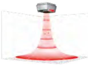
Mode chauffage : l'air pulsé est plus chaud que l'air ambiant et donc plus léger. Cet apport d'air à la verticale permet d'acheminer la chaleur là où l'on en a besoin.
